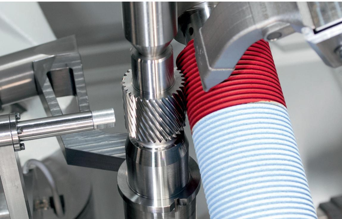
1 Blick in den Arbeitsraum eines Verzahnungszentrums, auf dem Zahnräder für die Elektromobilität mit den geforderten High-End-Oberflächen gefertigt werden können © Kapp Niles
