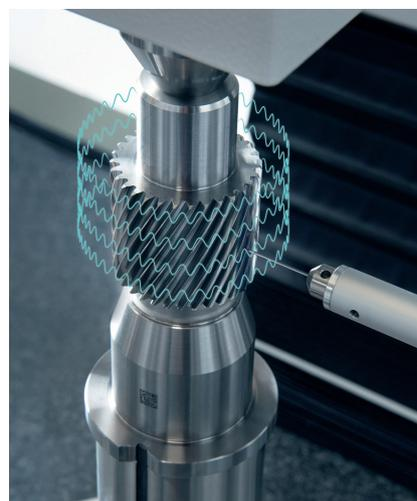
4 Welligkeitsanalyse auf einer 'KNM 2X'-Messmaschine © Kapp Niles
